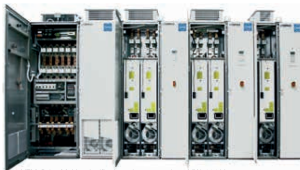
VEMoDrive Multi - pienjännitetaajuusmuuttaja, 5 MW, 690 V Käyttö esimerkiksi 690 V:n tuulettimissa: 1 x 485 kW, 1 x 450 kW, 1 x 400 kW
