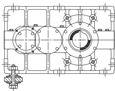
I riduttori per applicazione pendolare vengono forniti con vincolo elastico, semielastico e rigido.
