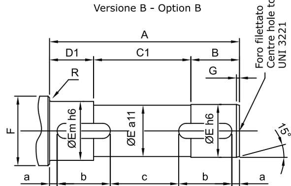
Linguette dimensionate su E in accordo con UNI 6604 - Keys dimensioned on E to UNI 6604
