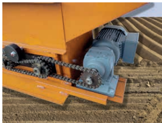
Remetin hihnavetoiseen vihanneskuljettimeen on valittu KEBin G-lieriöhammasvaihdemoottori
